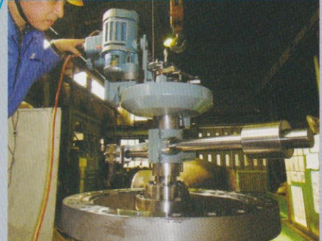
ガスケット面の修正加工
