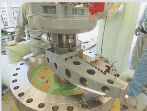
■ フランジ面修正加工 【径φ100～φ2000】
